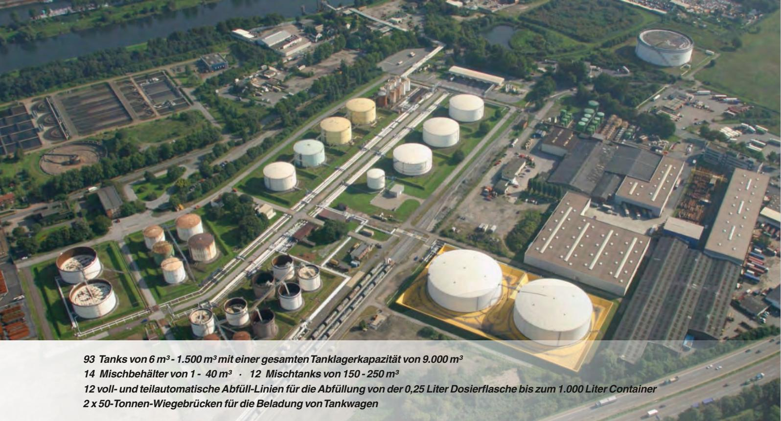
93 Tanks von 6 m<sup>3</sup> - 1.500 m<sup>3</sup> mit einer gesamten Tanklagerkapazität von 9.000 m<sup>3</sup>
